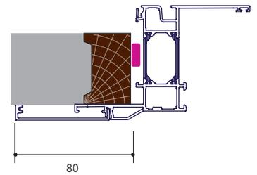
**Fig 10. Variante avec seuil en aluminium**
