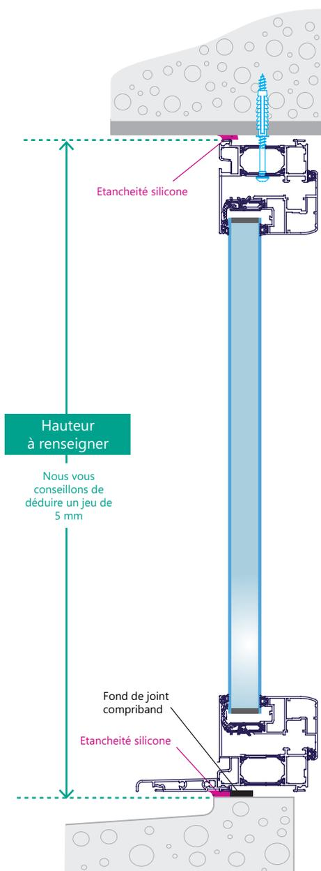
**Fig 22.** Coupe verticale **avec volet roulant**
