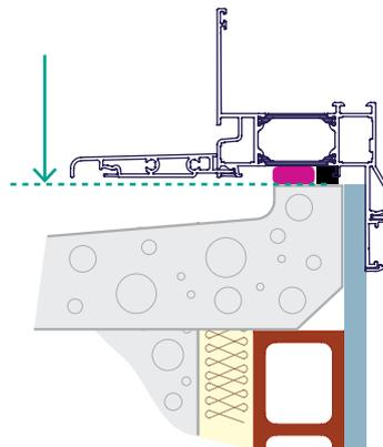
**Fig 5. Variante avec seuil en aluminium**
