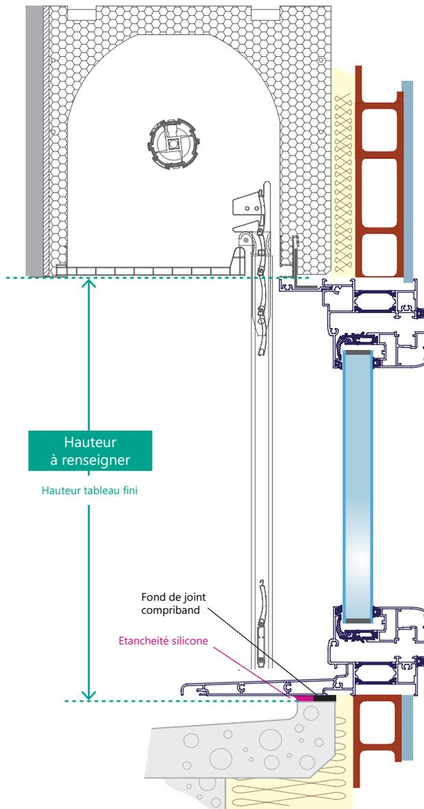
**Fig 19.** Variante avec seuil en aluminium
