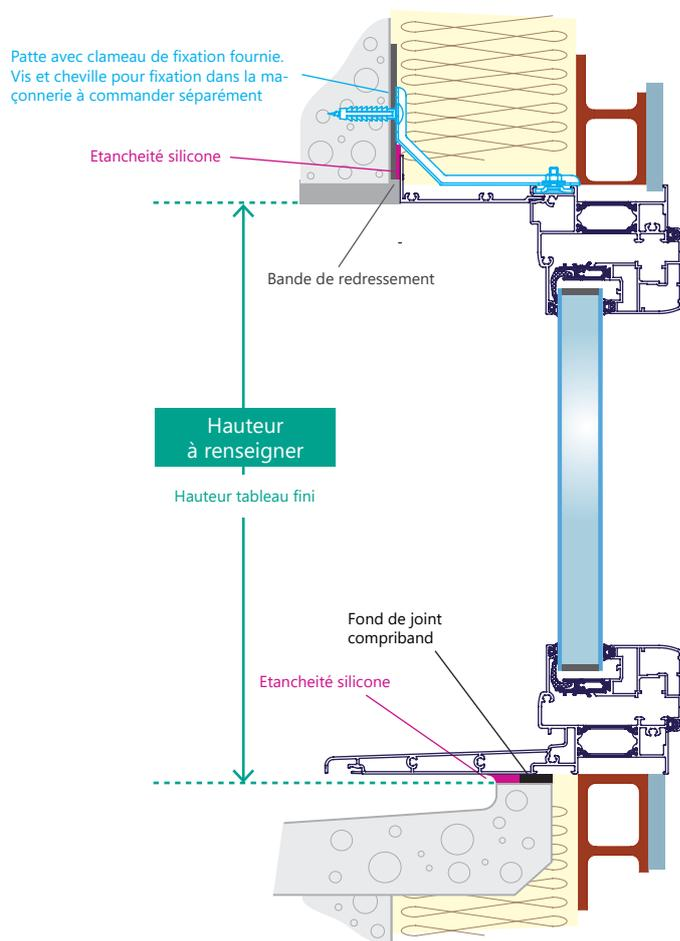
**Fig 13.** Variante avec seuil en aluminium
