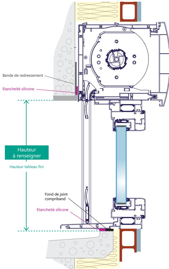
**Fig 16.** Variante avec seuil en aluminium
