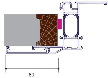
**Fig 4. Variante avec suppression de l'appui en bois**
