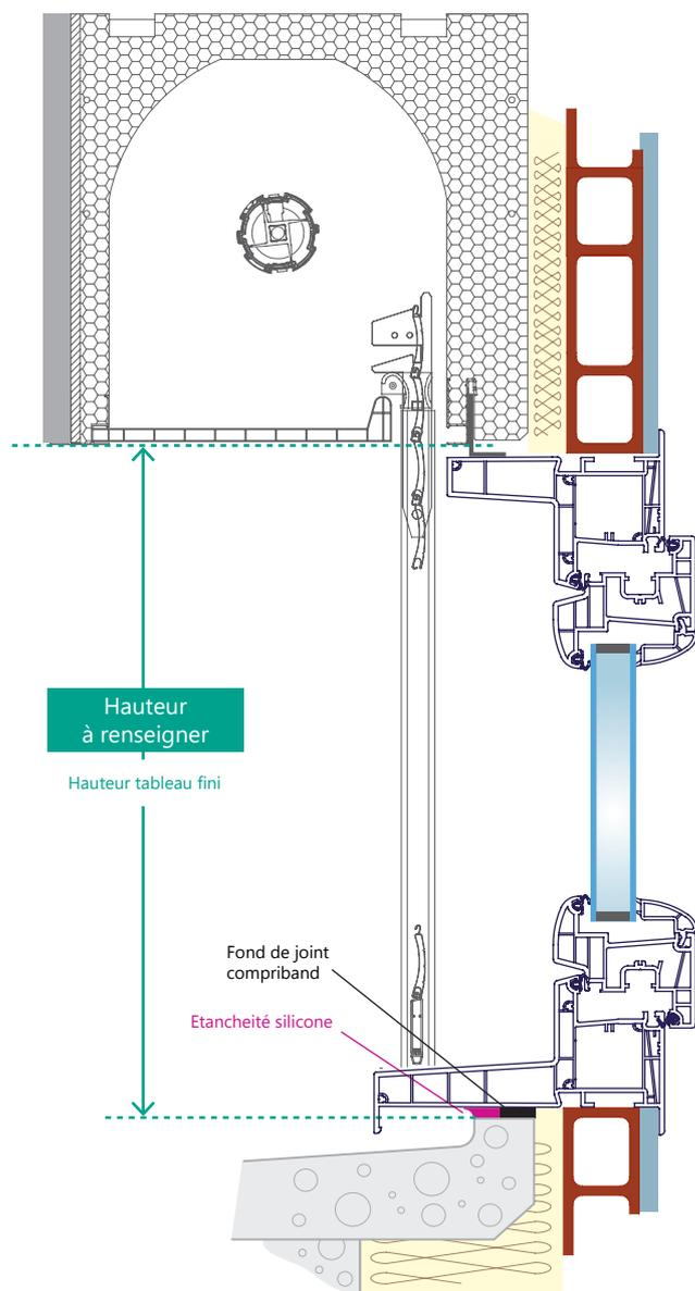
**Fig 29.** Variante avec seuil en aluminium
