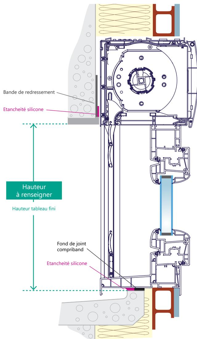
**Fig 26.** Variante avec seuil en aluminium
