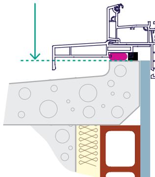
**Fig 5. Variante avec seuil en aluminium**
