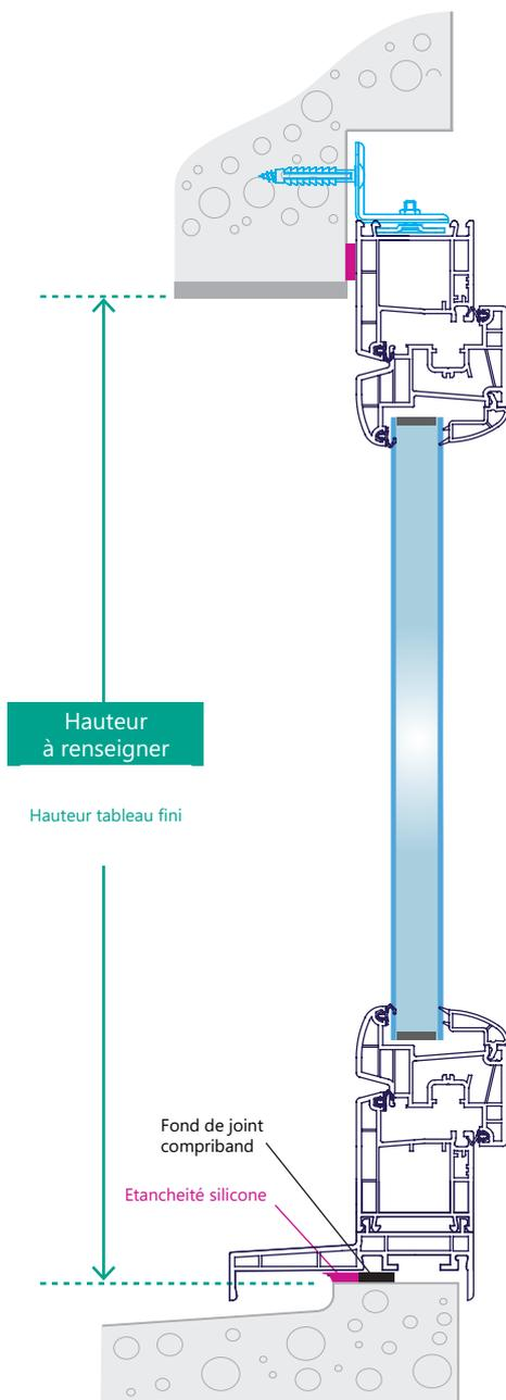
**Fig 35.** Coupe verticale **avec volet roulant**
