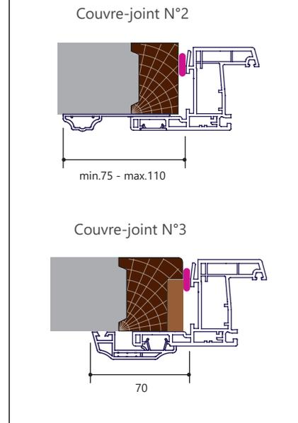
**Fig 20. Variante avec seuil en aluminium**
