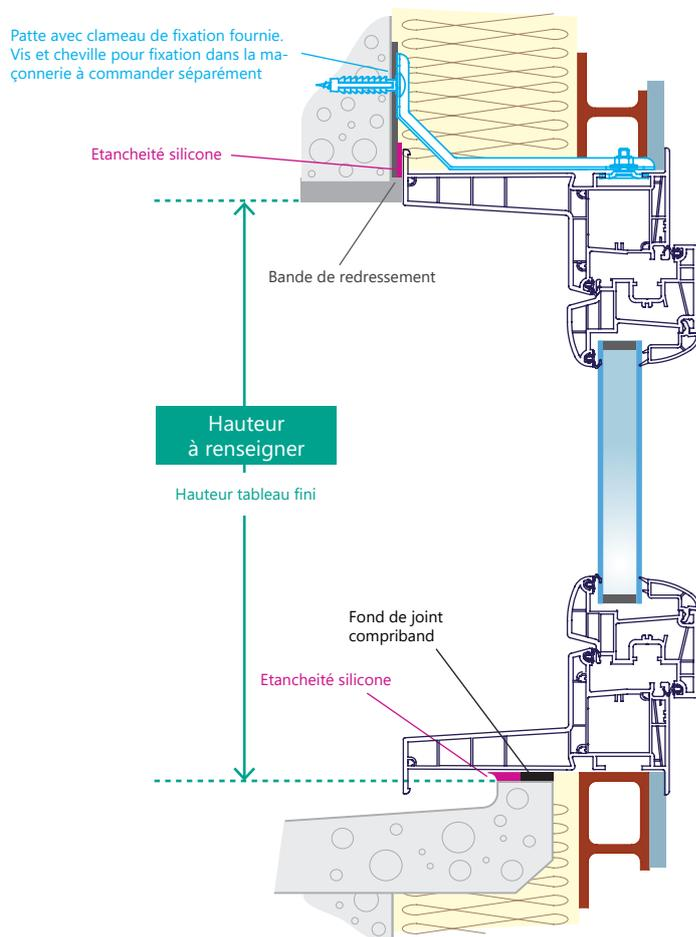
**Fig 23.** Variante avec seuil en aluminium
