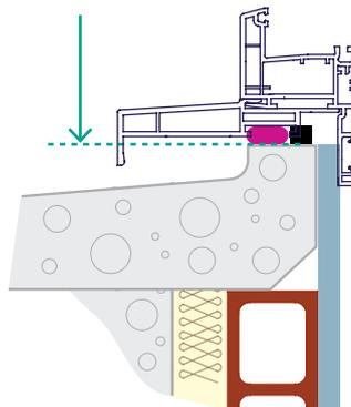
**Fig 15. Variante avec seuil en aluminium**
