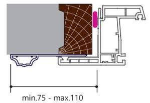
**Fig 10. Variante avec seuil en aluminium**
