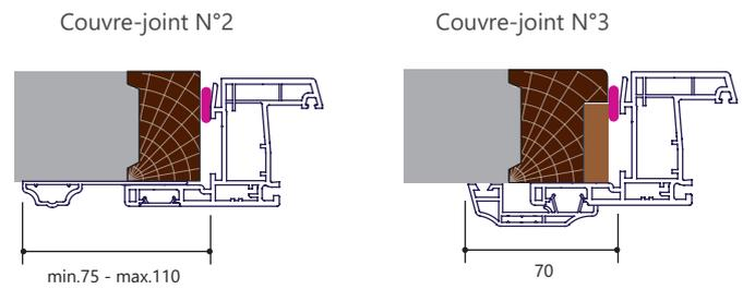
**Fig 14. Variante avec suppression de l'appui en bois**
