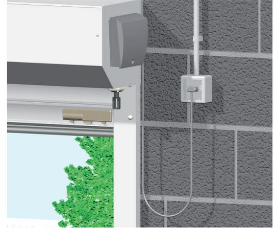
Brancher le câble d'alimentation à une prise de courant équipée d'une protection 16A
