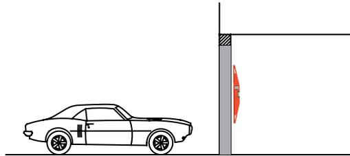
Le sol ne doit pas présenter de défaut de niveau et de planéité supérieur à 7 mm ( risque de mise en sécurité de la porte ).
