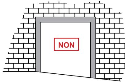
Si les murs ne sont pas plan, prévoir des câbles de rattrapage permettant au coulisses d'être fixées parallèlement.
