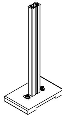
3 - Fixation du poteau au renfort par 4 vis 4 x 10
