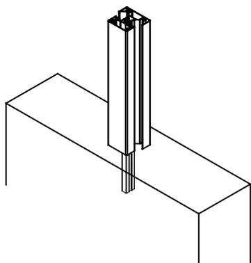
3 - Insertion de cloisir de 15 mm pour créer un jeu sous la première lame
