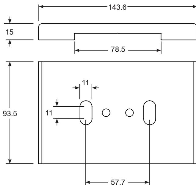
1 - Fixation d'un renfort de 300 mm à la platine par 2 vis Ø6.3 x 80
