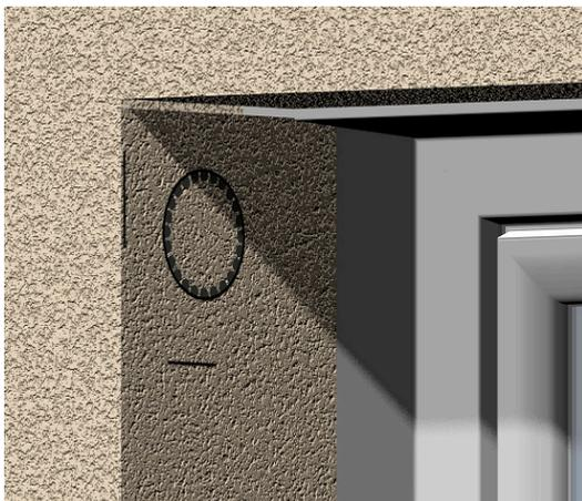
Pour réaliser le passage du treuil, percer plusieurs trous au perforateur sur le tour du tracer et terminer le défonçage au burin.
