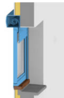
Pose en rénovation Coffre est au-dessus du linteau
