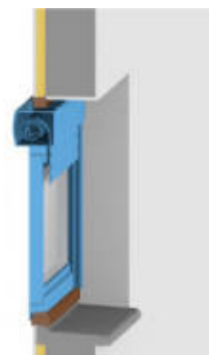
Pose en rénovation Coffre visible de l'extérieur
