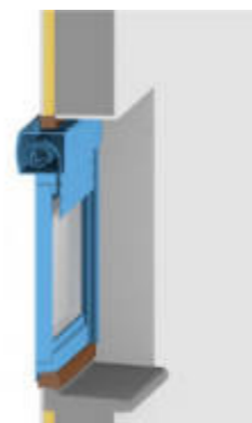
Pose en rénovation Coffre visible de l'extérieur
