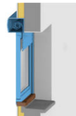
Pose en rénovation Coffre est au-dessus du linteau
